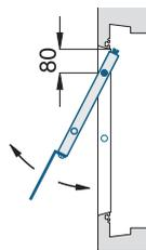
Bemerkung: Das Winkelprofil 10 91 08 wird 20 mm länger als die lichte Breite des Fensterblendrahmens gefertigt.
